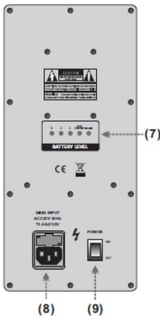
7. Indicatore del livello della batteria. Quando l'unità è accesa, questo indicatore a 4 LED indica il livello di carica della batteria. La durata della batteria varia a seconda dell'utilizzo e del volume di uscita.
